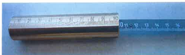
Bild 4: Beispiel Maßteilung beginnt direkt auf dem Senkgewicht und das Maßband führt dann die Maßteilung weiter
